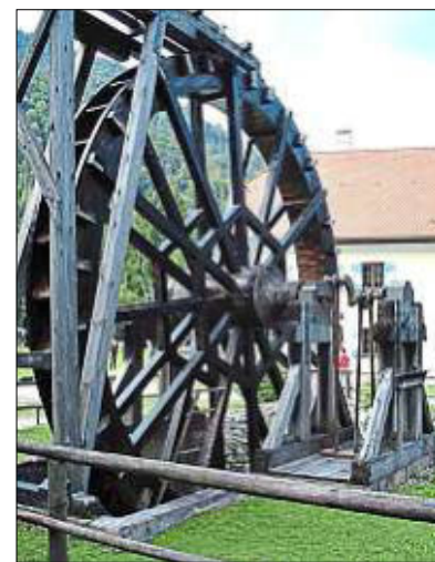
Wasserrad und Pumpe eines Brunnhauses. Der Nachbau kann im Holznechtmuseum Ruhpolding besichtigt werden.
